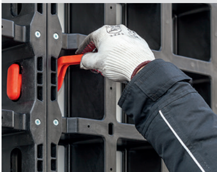
将DUO扣件插入细长底座的开口中并旋转90°
