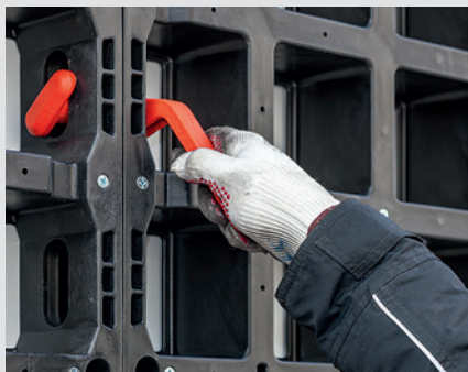
这种连接方式可以确保所有模板都处于同一平面。由于扣件与模板齐平, 所以可以将较大的预装单元
